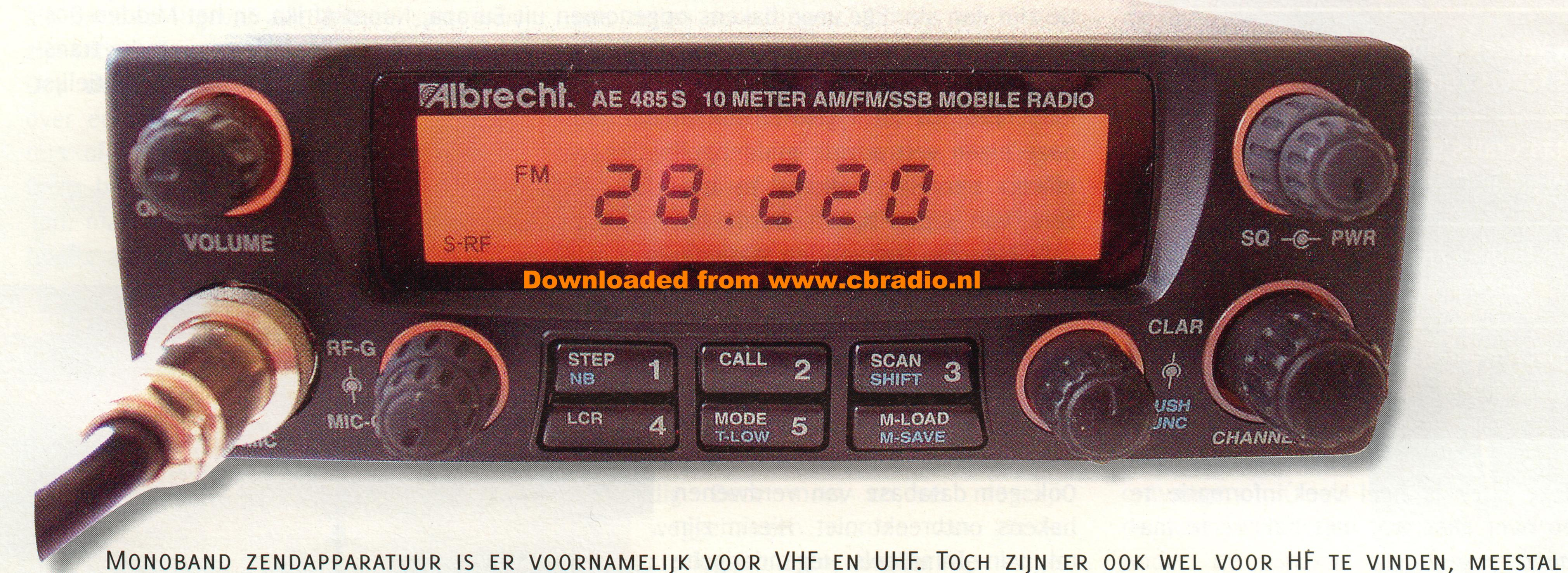
VOOR TIEN METER. DE GOEDKOPERE ZIJN PRIMA GESCHIKT VOOR C-AMATEURS DIE MET HET VERVALLEN VAN DE MORSE-VERPLICHTING VOORZICHTIG EENS IETS OP HF WILLEN PROBEREN. RAM KON DEZE ZOMER DE ALBRECHT AE 485 S UITPROBEREN. EEN 10 METER TRANSCEIVER MET SSB, FM EN AM VOOR MOBIEL GEBRUIK, DUS OOK UITERMATE GESCHIKT VOOR OP CAMPING OF BOOT.
