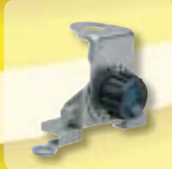
SP-S cod. T 752 Edelstahl-Antennenhalter für universal- PKW-Anbau. Mit Reduzierstück zur zentrischen Montage von Antennenfüßen am Kofferraumdeckel, Heckklappe oder anderen horizontalen Kanten von Metallflächen. Die Antennenneigung ist in seitlicher und in Fahrtrichtung justierbar. Inklusive Schutzformteil für Kfz gegen Beschädigung.
