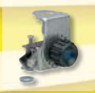
GR-S cod. T 753 Edelstahl-Antennenhalter für PKW- Dachrinnenmontage mit Reduzierstück zur zentrischen Montage von Antennenfüßen an PKW-Dachrinnen. Die Antennenneigung ist in seitlicher und in Fahrtrichtung justierbar.
