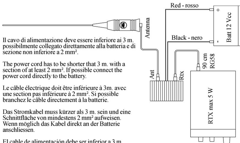
Il cavo di alimentazione deve essere inferiore ai 3 m. possibilmente collegato direttamente alla batteria e di sezione non inferiore a 2 mm<sup>2</sup>.
