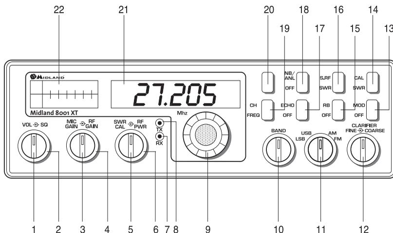
1. **ON/OFF VOLUME (Potentiomètre interne).** Tourner dans le sens horaire pour allumer l'appareil et pour régler le niveau sonore. Pendant l'utilisation normale de la CB, le potentiomètre de volume est utilisé pour le haut-parleur interne, mais aussi pour l'externe s'il est raccordé.
