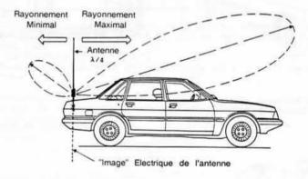
Si l'on déplace l'antenne vers l'arrière du véhicule, la plus grande surface métallique "vue" par l'antenne étant située vers l'avant du véhicule, c'est dans cette direction que le rayonnement est maximal.
