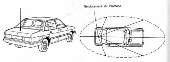
En disposant l'antenne sur le coffre du véhicule, son rayonnement horizontal se trouve avantagé vers l'avant de celui-ci.
