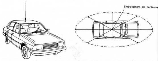
Lorsque l'antenne est placée en position centrale du toit du véhicule, le diagramme de rayonnement horizontal s'apparente à une elipse.
