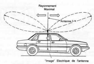
Quand on monte une antenne au centre du toit d'un véhicule, les surfaces métalliques situées de part et d'autre de l'antenne étant similaires, les lobes du rayonnement vertical sont renforcés de manière identique vers l'avant et vers l'arrière.
