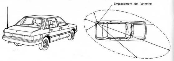
Une position dissymétrique de l'antenne au niveau du véhicule a pour conséquence une inclination (vers la droite dans l'exemple choisi) de l'axe principal de rayonnement horizontal.
