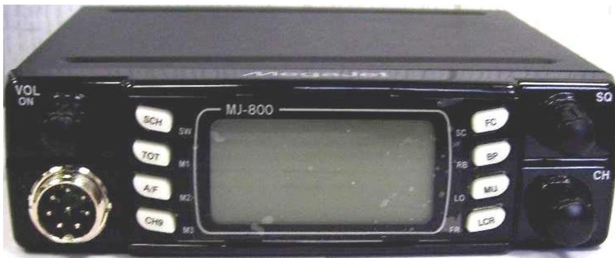
1) Регулятор **VOL/ON**. Предназначен для включения/выключения радиостанции и регулировки громкости.
