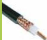
Коаксиальный кабель RG-213 предназначен для коммутации высокочастотных цепей радиооборудования. Благодаря большому диаметру и плотной оплётке, состоящей из медных проводников, кабель хорошо подходит для работы в диапазонах HF и VHF. Волновое сопротивление - 50 Ом. Материал проводников - медь. Диэлектрик центральной жилы - полиэтилен. Внешний диаметр - 10,3 мм.
