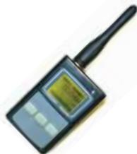
OPTIM FC-01 – компактный частотомер, предназначенный для дистанционного измерения частоты периодических колебаний, с возможностью индикации уровня входного сигнала в диапазоне от -40 до +15 dBm.
