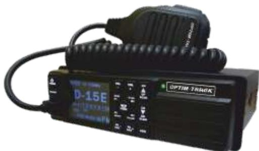
Представляем вам новую радиостанцию ОПТИМ TRUCK с питанием от источника напряжения от 12 до 24 В. Радиостанция предназначена для диапазоне частот 27 МГц в автомобиле или в качестве базовой радиостанции. Удобный TFT дисплей с возможностью ночного режима обеспечивает удобство в пользовании.
