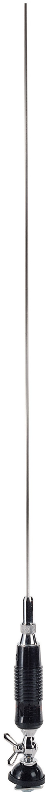
ANT0422 SUNKER ELITE CB102 Częstotliwość: 27MHz Wzmocnienie: 4dB V.S.W.R: 1,3:1 Impedancja: 50ogm Moc max: 150W Długość: 1,35m Waga: 300g Montaż: fi 12,5mm
