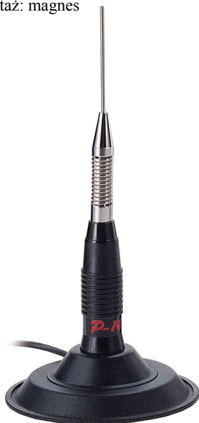
ANT0426 SUNKER ELITE CB106 Częstotliwość: 26-28MHz Wzmocnienie: 4dB V.S.W.R: 1,1:1 Impedancja: 50ohm Moc max: 500W Długość: 1,53m Waga: 1,2kg Montaż: magnes
