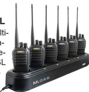
6er Sets mit 6-fach Multilader **MLG-6 SL** für das TeCom-SL bieten wir die 6-fach Multi-Ladestation MLG-6 SL (PR2391) als optionales Zubehör an. Ausgestattet mit Überladeschutzfunktion, können hiermit 6 TeCom-SL bzw. deren Akkupacks unabhängig voneinander geladen werden.
