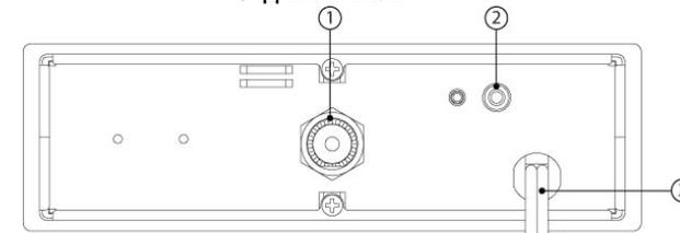
1. Разъём для подсоединения кабеля антенны с разъемом PL-259.
